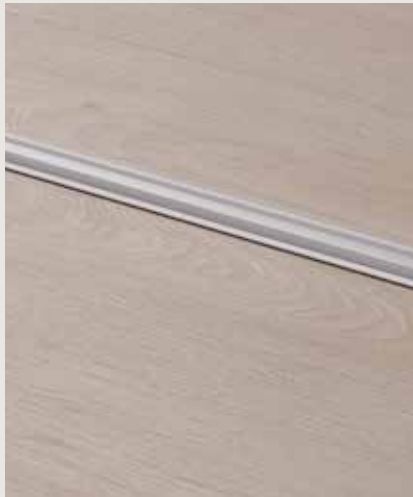
PERFIL MULTIUSO, PLATA 1860 × 47 × 16 mm Perfil y adaptador de dilatación todo en uno. Adecuado para diferencias de altura de entre 0 y 12,3 mm. Peso: 10 mm (no instalado). Aluminio. PGPRSILV
